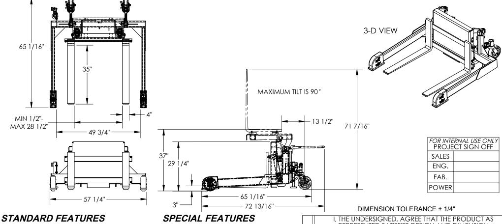
MODEL NUMBER IS TMS-20-DC CAPACITY IS 2,000 lbs FORK ADJUSTMENT IS 1/2" TO 28 1/2" I.D. OPERATOR REACH IS 13 1/2" STRADDLE I.D. IS 49 3/4" FORK WIDTH IS 4" **USABLE FORK LENGTH IS 35"** OVERALL WIDTH IS 57 1/4" OVERALL LENGTH IS 72 13/16" OVERALL HEIGHT IS 29 1/4" LOWERED FORK HEIGHT IS 3" **ROTATED HEIGHT IS 37"** INCLUDES FLOOR LOCK 12 VOLT DC POWERED ON-BOARD BATTERY CHARGER CHARGER INDICATOR ALL BATTERY CHARGERS ARE 115V AC
