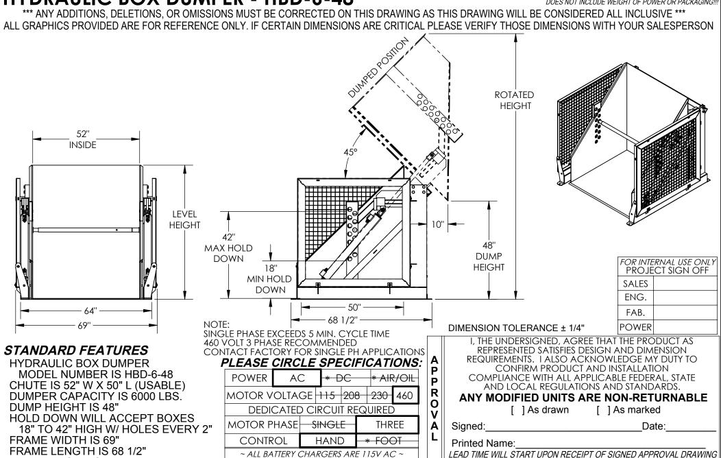
FRAME LENGTH IS 68 1/2" LEVEL HEIGHT IS 65" **ROTATED HEIGHT IS 129 1/2"** DUMP ANGLE IS 45° CHROME PLATED CYLINDER WITH EMERGENCY STOP VELOCITY FUSE PAINT IS VESTIL ROYAL BLUE
